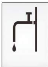
Внимание: Водный тракт, утопленный в стену
